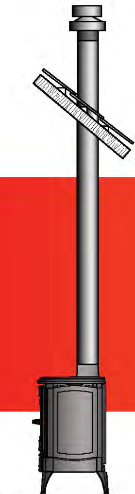
In configurazione verticale è possibile raggiungere fino a 12 metri di altezza a partire dal collarino della stufa.
